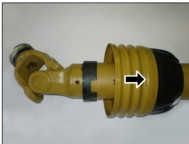
Skub skjoldet tilbage for at afsløre universalleddet
