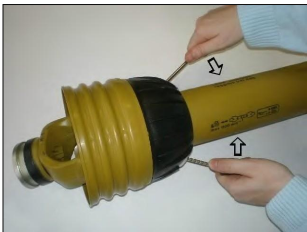
Låsene åbnes for at frigøre skjoldet
