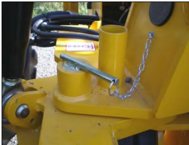
Slew Locked – altid til transport og opbevaring Slew Unlocked – kun til arbejde
