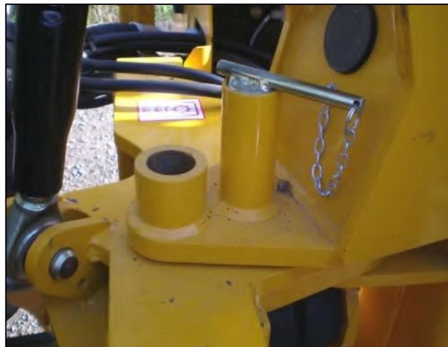
Slew Locked – altid til transport og opbevaring Slew Unlocked – kun til arbejde
