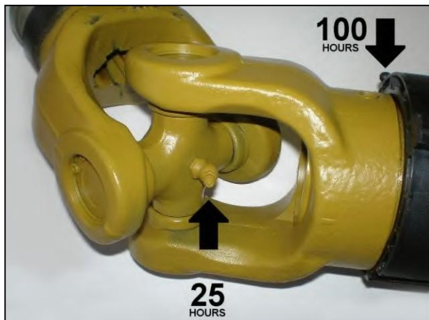
Skub skjoldet tilbage for at afsløre universalleddet
